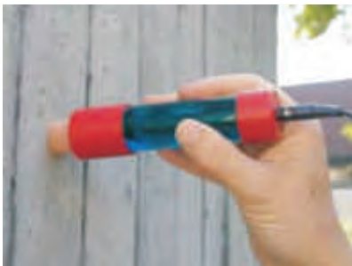
Electrodo de barra de media celda estándar. Incluido en QC330 y QC330X
