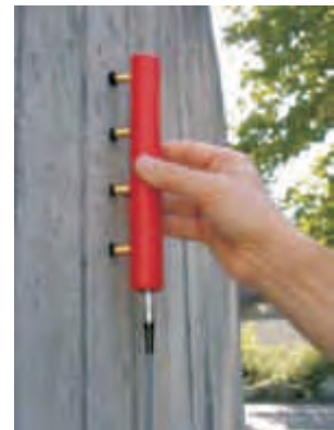
Sonda Wenner de cuatro puntos. Incluido en QC330R y QC330X
