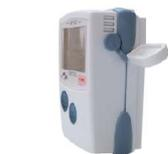
Para abrir: introducir la llave en el centro del sistema de fijación y dar 1/4 de vuelta.
