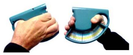
Haciendo coincidir el punto de mira con el objeto visado, a continuación se bloquea la aguja con la palanca de bloqueo B y podemos ver la lectura de altura en la escala correspondiente a la distancia prefijada, de igual manera podemos leer el ángulo de pendiente en la escala de grados de pendiente
