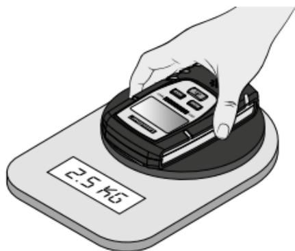
Apoyar las almohadillas sensoras completamente sobre el material a medir y presionar el aparato con una presión aproximada de 2,5 kg. **CONSEJO:** probar la fuerza de presión con una báscula
