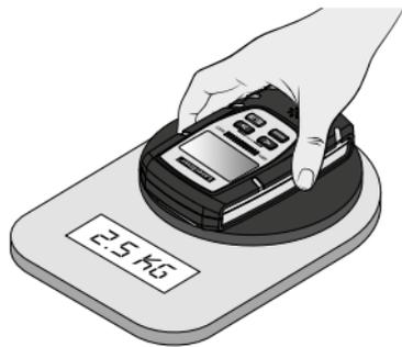
Apoyar las almohadillas sensoras completamente sobre el material a medir y presionar el aparato con una presión aproximada de 2,5 kg.
