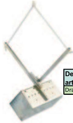
El cactador de acero inoxidable se diseño para el uso en fondos suaves (arena o cieno). Un disparador simple sostiene el cactador abierto mientras baja para cubrir un área uniforme. El diseño de tijera cierra el cactador, recuperando un volumen de sedimento de la superficie para el análisis.
