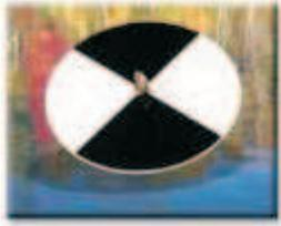
Determine la turbidez o el grado de visibilidad en aguas naturales. El disco cargado de 20 centímetros de diámetro tiene una cuerda estirar-resistente trenzada que esté marcada cada medio metro y en cada metro hasta 20 metros.
