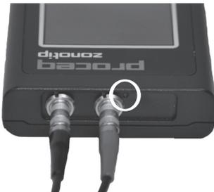
Figura 3: Conexión del transductor de 4.0 MHz. Asegurarse de que el cable rojo esté conectado en el puerto con el punto rojo.
