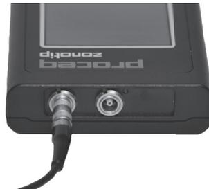
Figura 4: Conexión del transductor de 2.5 MHz
