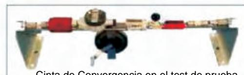
Cinta de Convergencia en el test de prueba con reloj comparador digital
