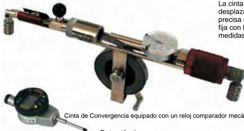
Cinta de Convergencia equipado con un reloj comparador mecánico o digital(izquierda),
