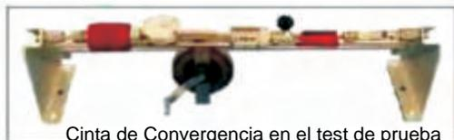
Cinta de Convergencia en el test de prueba con reloj comparador analógico
