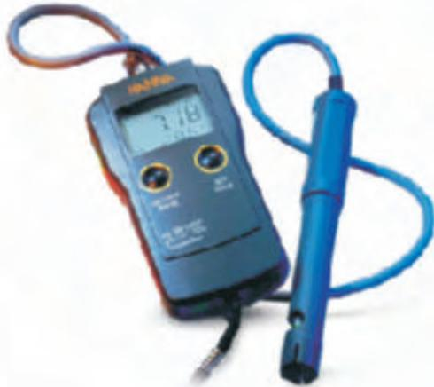
PH 991300 y PH 991301 pueden realizar mediciones de pH, conductividad, TDS (sólidos totales disueltos) y temperatura.
