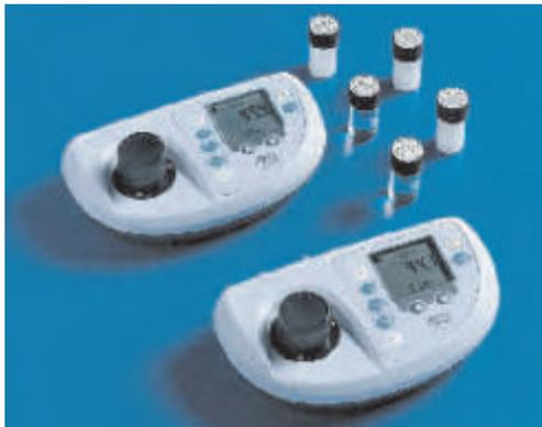
Turbidímetro digital de laboratorio portátil para determinar la turbidez en aguas potables, residuales y líquidos de proceso. Conforme a los principios de medida nefelométrico de acuerdo con la ISO 7027
