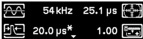
Frecuencia Tx, calibración, duración de pulso, corrección de temperatura
