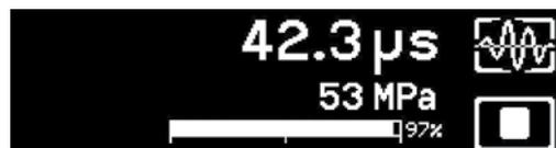
Medición de la resistencia a la compresión (Pundit Lab<sup>+</sup>)
