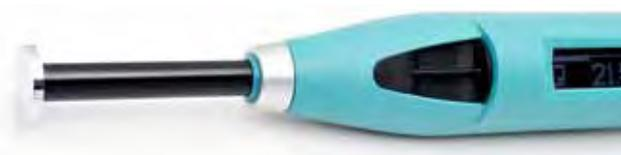
Lo mismo, sumado a la independencia del ángulo inherente, lo convierte en la herramienta perfecta para aplicaciones de resistencia inicial como la determinación del momento de quitar los encofrados, en revestimientos interiores de túneles.
