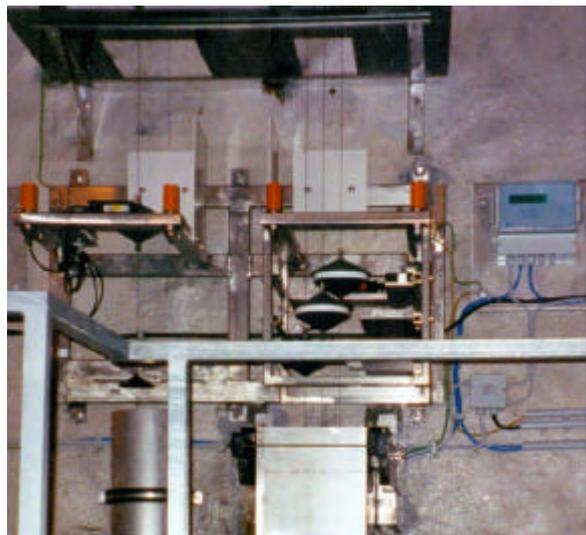
Sección combinada de péndulo directo e inverso con sensor electrónico mod. LL02-25
