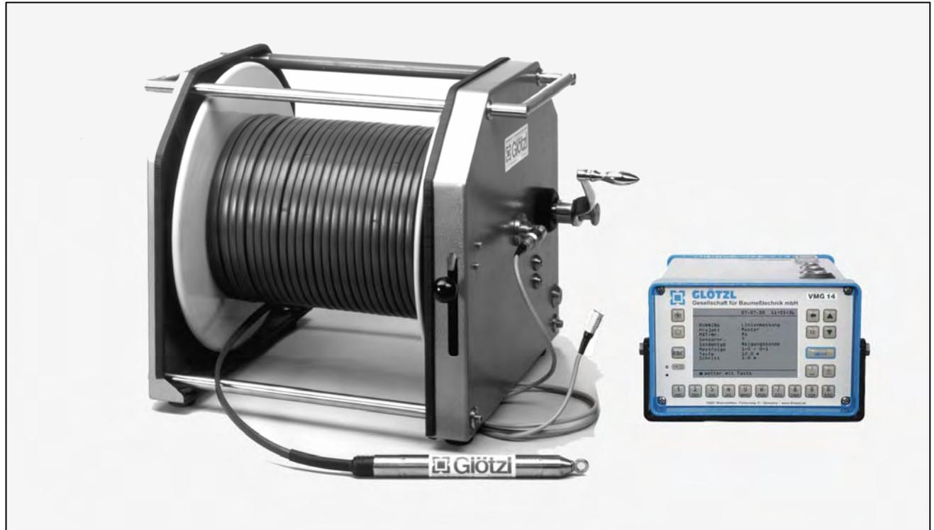
La línea de asientos hidrostática sirve para la medición absoluta de la altura en tuberías horizontales ó ligeramente inclinadas. Al recorrer la tubería con el sensor, se determina en puntos previamente escogidos, la diferencia de altura entre el sensor y el punto de altura de referencia en el comienzo de la tubería. La comparación entre dos lecturas en diferentes momentos da el asiento de la tubería.
