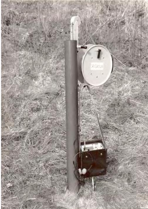
Fig.: Equipo de medición con tubería guía
