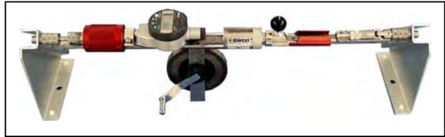
**Fig:** Cinta de convergencias con comparador analógico sobre el marco de calibrado.
