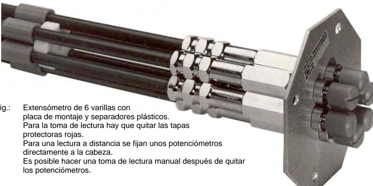
Fig.: Extensómetro de 6 varillas con placa de montaje y separadores plásticos.
