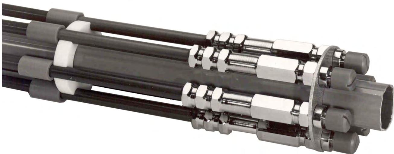
Fig.: Cabeza de extensómetro de 6 varillas modelo GKSE 6/16, Se compone de una tubería inclinométrica con 6 varillas simples y placa de montaje para la introducción en sondeos. Para la fijación de las varillas alrededor de la tubería inclinométrica se suministran los correspondientes separadores plásticos.
