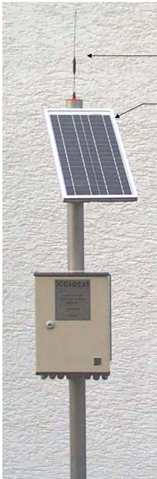
← Antena para modem GSM
