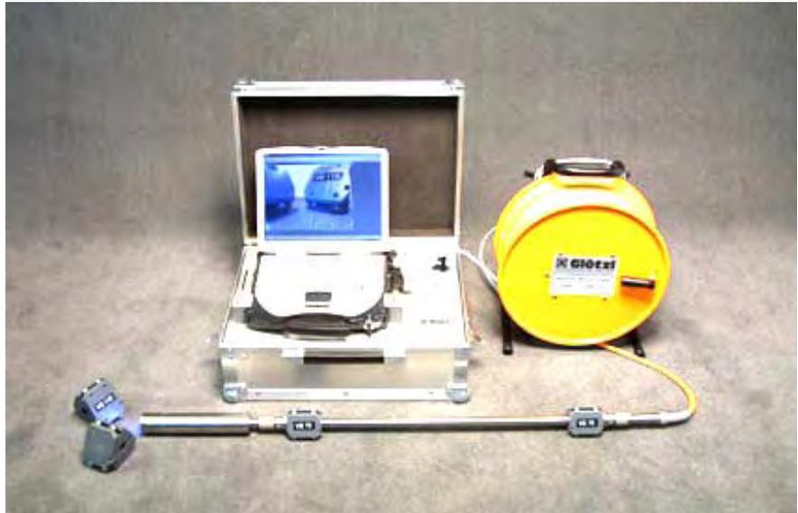
**Fig. 3** muestra un sistema de video autóctono con sonda de video, adaptador guía, carrete de cable y unidad de registro con ordenador portátil. Las piezas guías son intercambiables y se adaptan por lo tanto al diámetro del sondeo.
