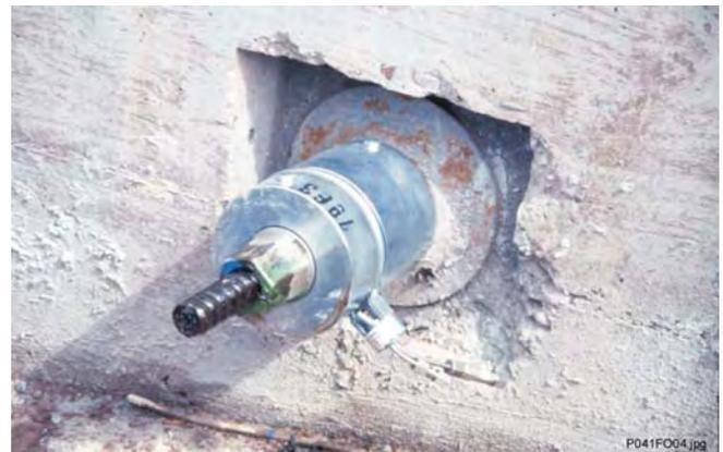
Fig.: Anclaje fijo con célula de carga
