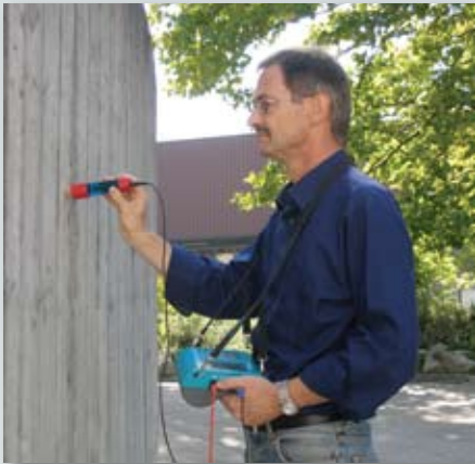
Medición con electrodo de varilla conforme a las normas.
