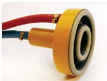
Celda de vacío de doble cámara con anillos de estanqueidad
