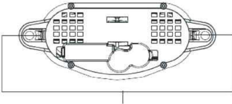
Presione la pestaña trasera para desbloquear la cubierta del pluviómetro
